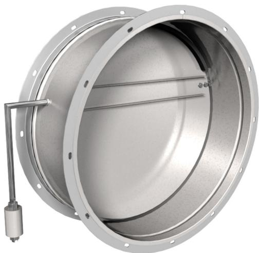
Предназначены для предотвращения перемещения воздуха через воздуховоды при остановленном вентиляторе. Клапаны с регулируемым упором можно использовать также для регулирования подачи воздуха в вентиляционных установках. Клапаны выпускаются двух типов, для воздуховодов круглого и прямоугольного сечений.
